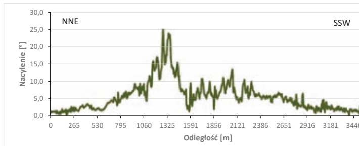
Ryc. 3. Profil topograficzny Łysogór (przez kulminację Łysicy) i Pasma Klonowskiego (przez kulminację Bukowej Góry). Przebieg profili pokazany na Ryc. 1. Zaznaczono średnie nachylenia w wybranych przedziałach wysokości n.p.m. na stokach północnych i południowych, a także zmiany w nachyleniu stoków wzdłuż całego ich zasięgu wysokościowego
