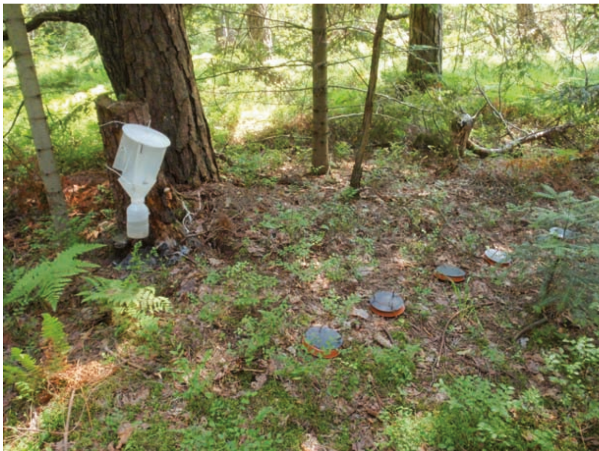
Ryc. 1. Jedna z dwóch pułapek barierowych IBL5 („Netocia”) zawieszona na próchniejącym pniaku po złamanym drzewie oraz 5 pułapek Barbera do odłowu fauny epigeicznej, zastosowane na stałej powierzchni kołowej (Fot. L. Buchholz)
