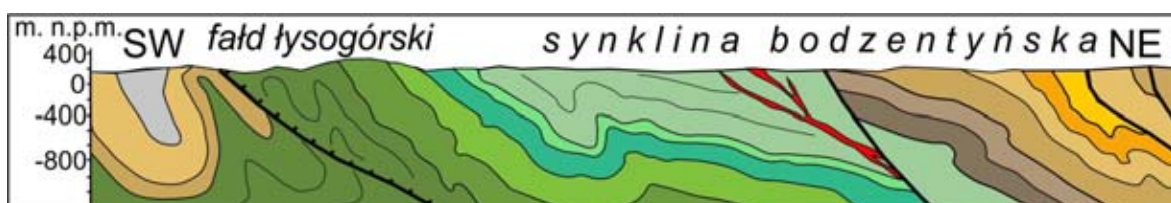
Ryc. 3. Przekrój geologiczny przez fałd łysogórski (Łysicy) oraz synklinę bodzentyńską przebiegający przez północno-zachodnią część Świętokrzyskiego Parku Narodowego (wg Filonowicz 1962, zmodyfikowany). Linia przekroju – patrz Ryc. 1; oznaczenia (kolory) wydzieleni geologicznych takie same jak na Ryc. 1.
